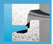
F 171 vor (li.) und nach (re.) der Montage (Gleitmanteldichtung und Lastausgleichsring)
