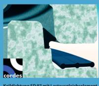
Keildichtung SD 97 mit Lastausgleichselement
