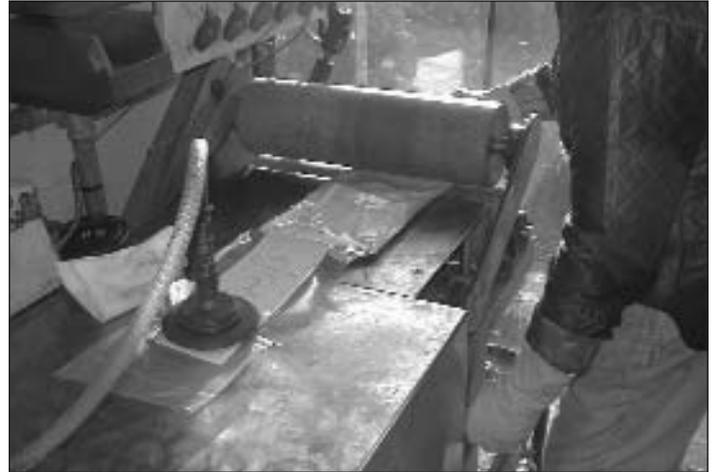
Abbildung 3: Imprägnierung eines Anschlusspassstückes nach den Vorgaben des Handbuchs
