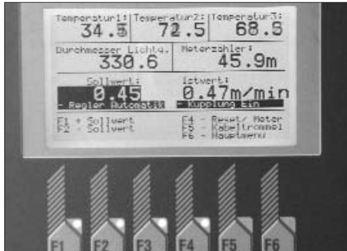
Abbildung 5: Dokumentation der Ist-Werte bei der Lichthärtung
