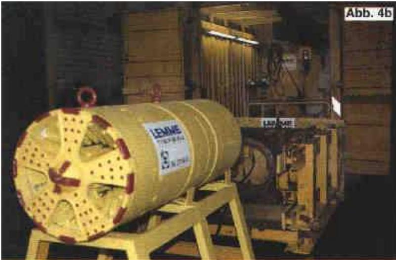
Steine der Zusatzklasse S 1 werden nur beherrscht, wenn sie in den Brecherraum gelangen, also bei nichtbindigen Böden ab DN 600. Das gilt auch für weiche und bindige Böden. Der Einsatz ab DN 400 ist möglich, wenn die Steine fest im Boden eingespannt sind, also bei Bodenklassen LBM 2/3 und LBO 2/3.
