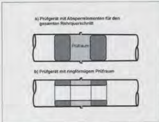
Prinzipische Zeichnungen der Prüfgeräte zur Durchführung einer Dichtungsprüfung einer Einzelrohrverbindung gemäß DWA-A 139.
