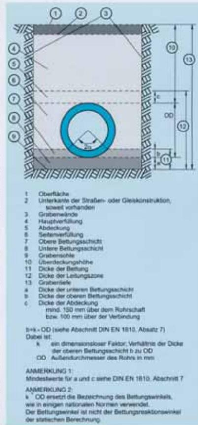
Bild 5: Zonen eines Leitungsgrabens nach DIN EN 1610 [9] - Leitungszone (Bettung, Seitenverfüllung), Abdeckung und Hauptverfüllung | Quelle: FBS
