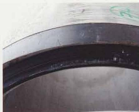
Die Vortriebsrohre sind mit einer speziellen Dichtung (EDAR Elastomer-Druckausgleichsring) ausgestattet, die eine ideale Druckübertragung beim Vortrieb auch bei engeren Kurvenradien ermöglicht und somit den Einsatz von Rohrlängen über 3 m erlaubt. | Foto: Güteschutz Kanalbau
